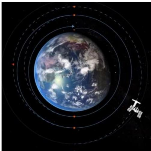
Рисунок 3 – Орбита фазирования (перехода между орбитами до сближения)
